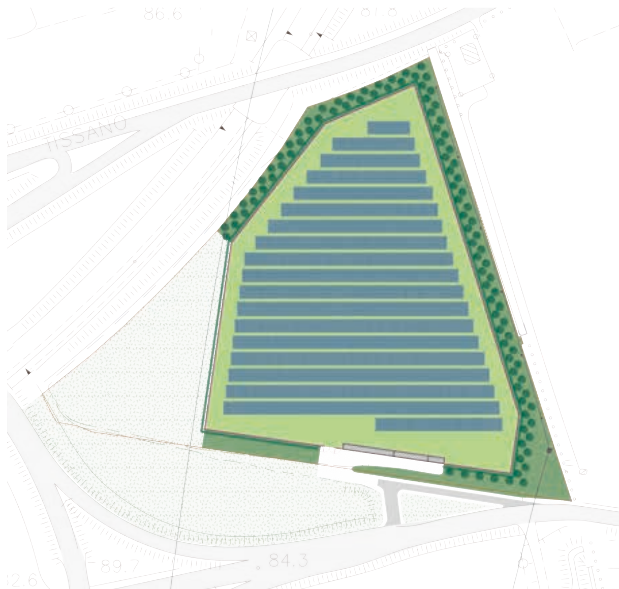
Fig. 44 - Planimetria delle opere di progetto con evidenziate la localizzazione delle mitigazioni di tipo arboreo e arbustivo.
