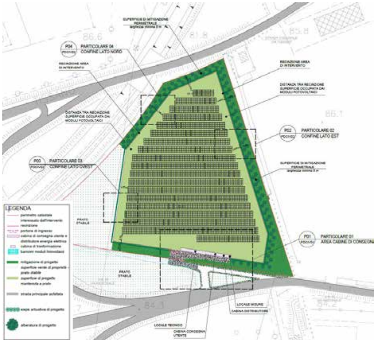
Fig. 29 - Planimetria generale del Parco Solare Milleacque. Dalla tavola di progetto PDCIV01.
